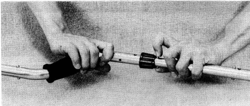
6. Вставьте нижнюю штангу в среднюю штангу таким образом, чтобы защелки попали в первый ряд отверстий. Затяните эксцентриковый замок.
