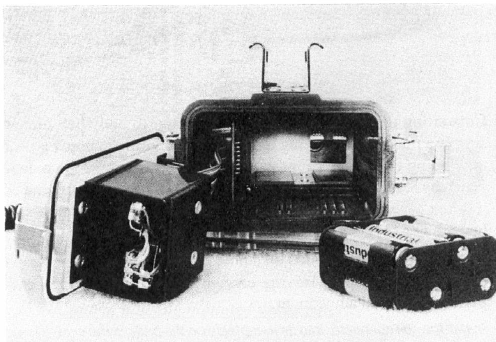
При установке или замене батарей убедитесь, что корпус прибора сухой. Затем отверните два болта, крепящих лицевую панель к корпусу. Аккуратно вытяните панель, стараясь не порвать или перекрутить провода, соединяющие панель с электронной печатной платой.
