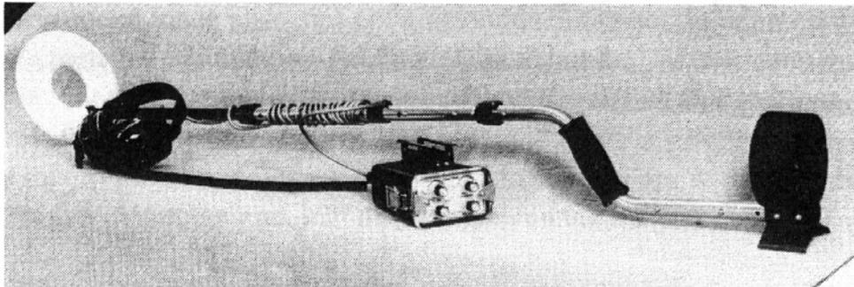
Для снятия электронного блока со штанги нажмите 4 пружинных защелки, которые удерживают электронный блок, и поднимите штангу. Для удобства одновременно нажимайте лишь на одну любую пару защелок.
