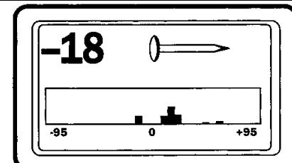
ЖЕЛЕЗО. Принято -18 или VISUAL DISC. = OFF.
