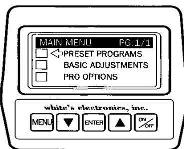
При положении триггера в центральной позиции, нажмите кнопку **ON/OFF**. Начнется автоматический запуск прибора.
