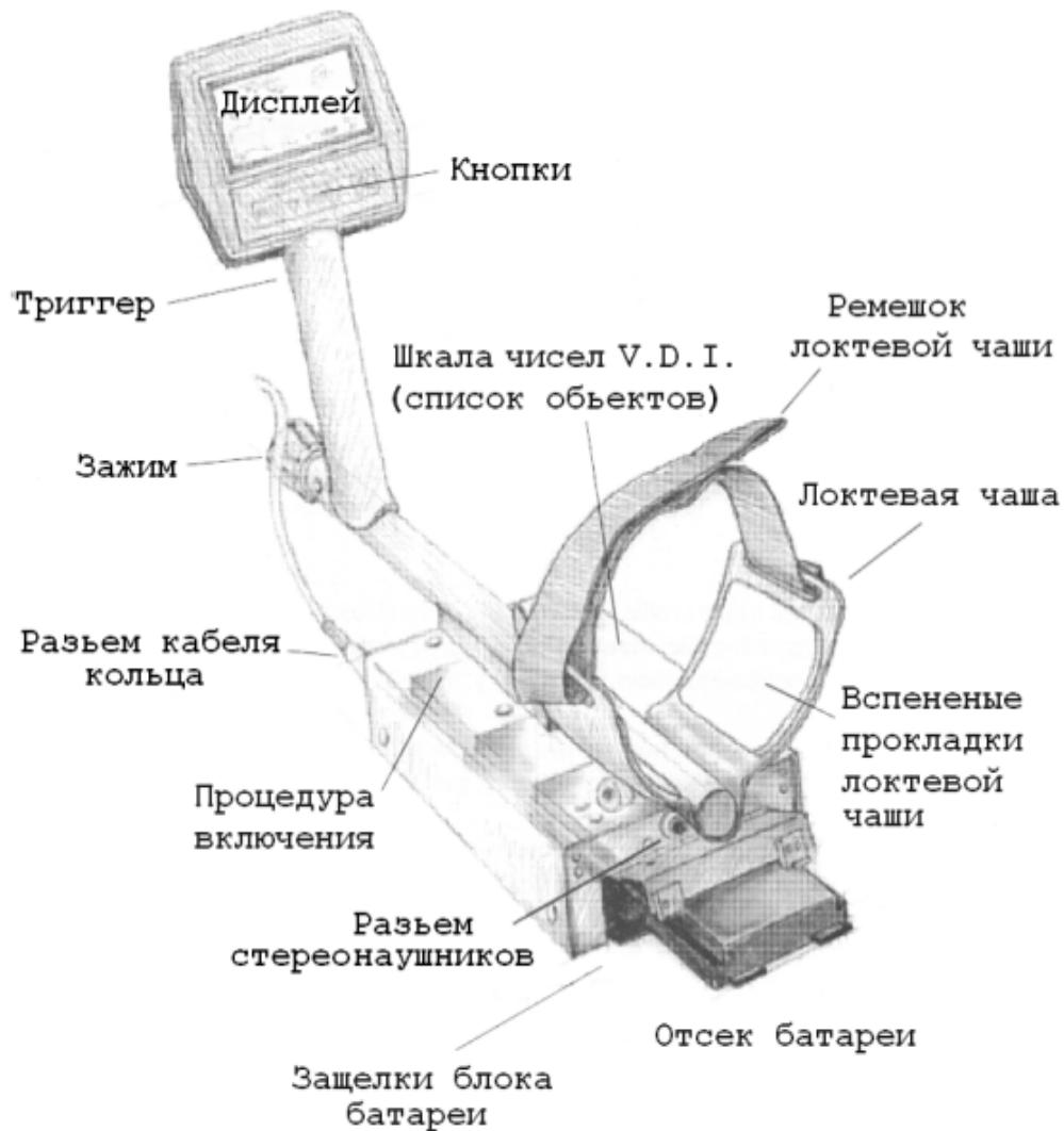
5. Отверните гайку зажима на штоке управляющего блока и вставьте в него S-образный шток, нажав подпружиненные кнопки нержавеющего замка так, чтобы они вошли в отверстия штока блока. S-образный шток должен стоять изгибом к дисплею. Однако те, кто предпочитает водить кольцом у самых ног, могутставить S-образный шток наоборот, т.е. изгибом к земле. Заверните гайку зажима. Вставьте штекер
